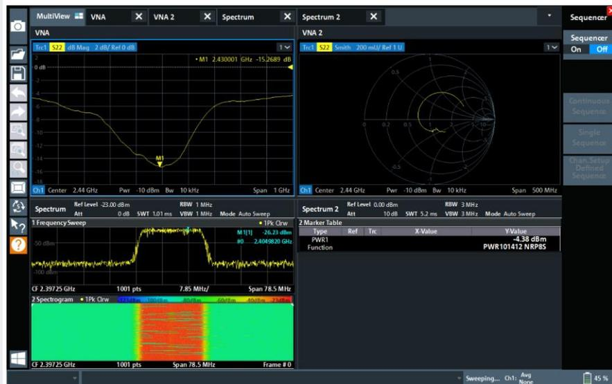
MultiViewにより、R&S ZNLで動作している全てのモードを一目で確認できます。この例では、スペクトラム・アナライザとネットワーク・アナライザの組み合わせが表示されています。このビューでは、すべてのモードが順番に更新されます。
