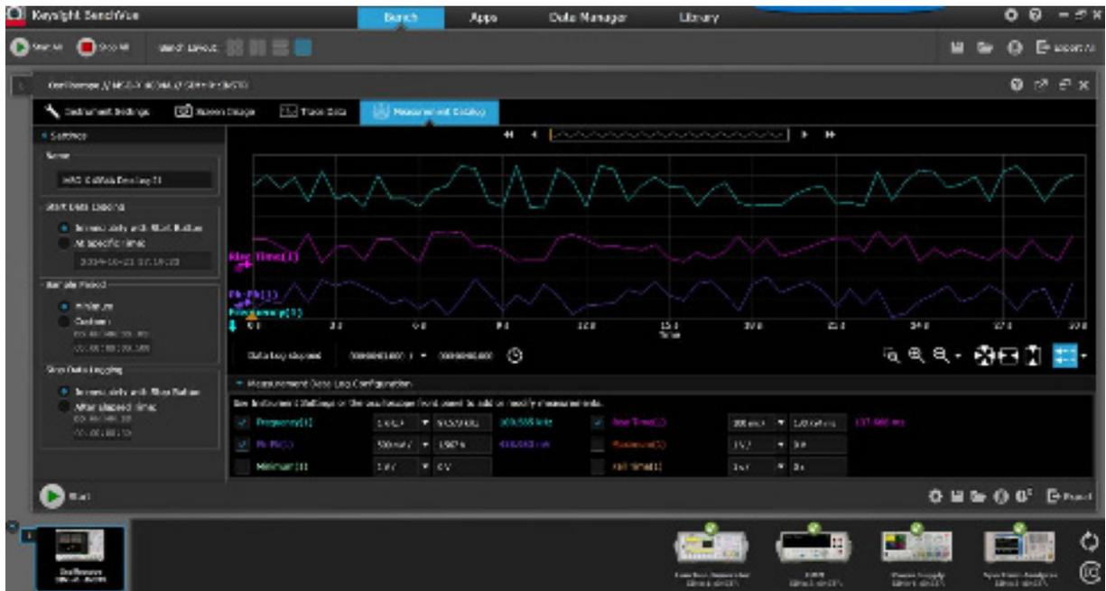
図5. BenchVueを使用した測定データのリモートロギング/プロット。
