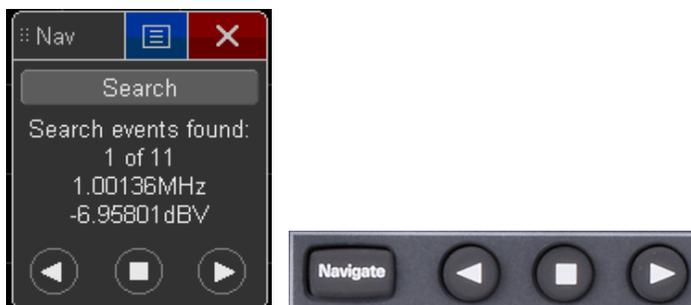
オシロスコープのフロントパネル上のボタンのクローズアップ写真。タッチ・ナビゲーション・コントロールも使用できます。
