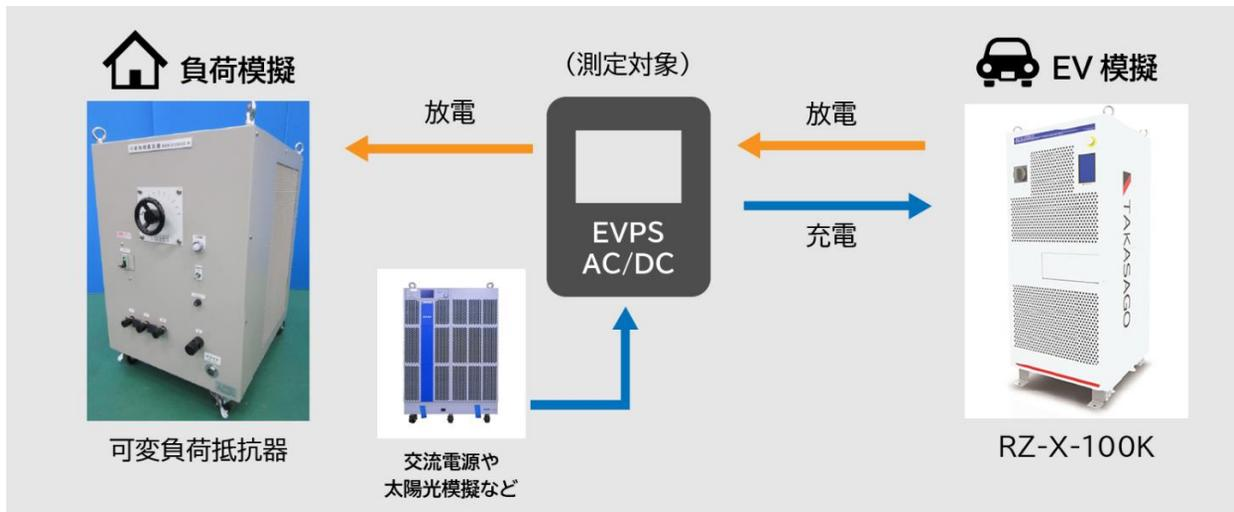
様々な容量での評価が可能（最大100kW） 電時におけるV2H充放電評価等に最適
