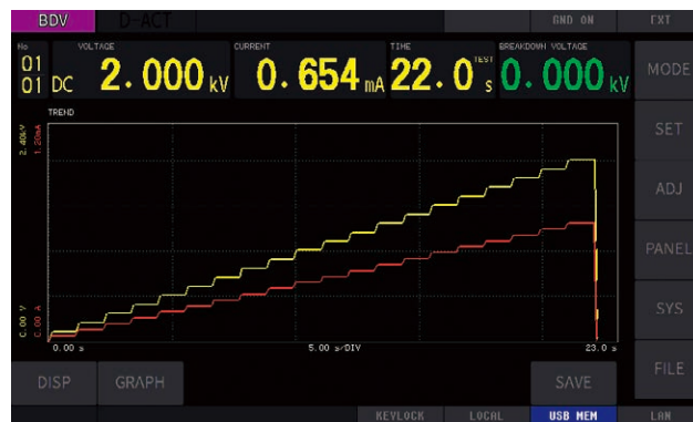
段階昇圧試験の例
