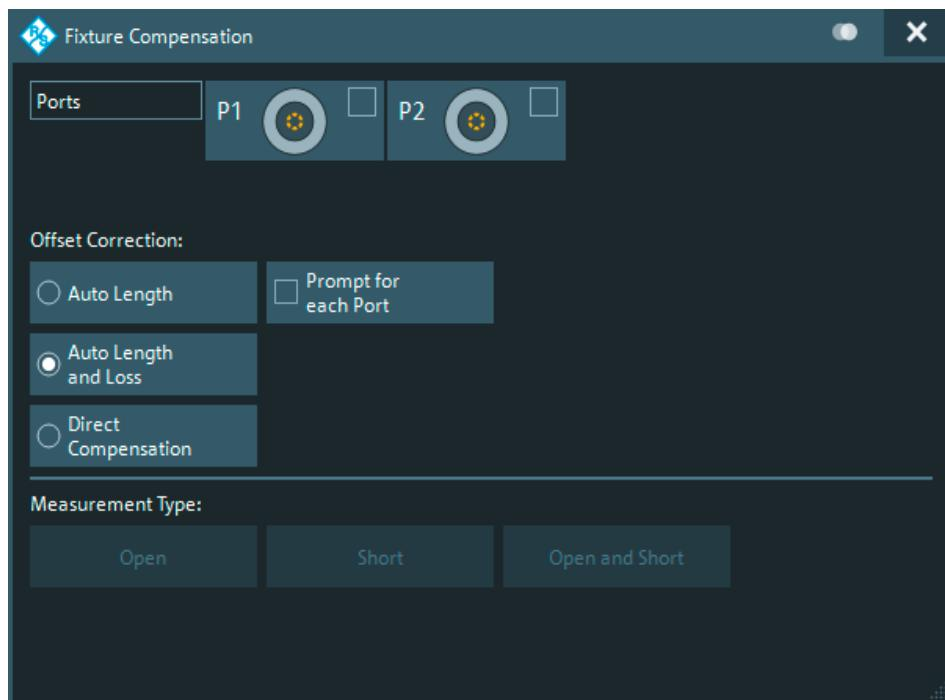
フィックスチャ補正メニューには、使用可能なすべての補正方法の概要が表示されます。
