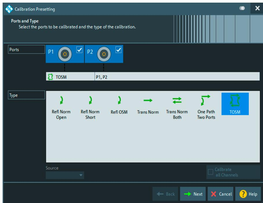
校正ウィザードには使用可能な校正方法の概要が表示され、簡単に選択できます。
