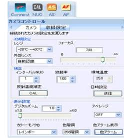
温度レンジ変更、ズーム設定、キャリブレーション実行等のカメラ遠隔コントロール
