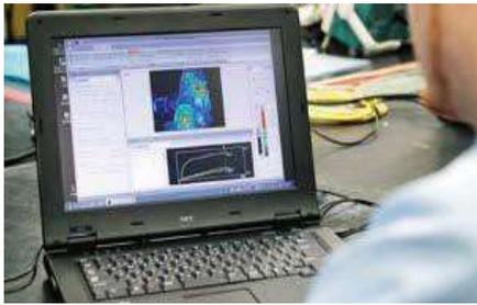
熱画像・可視画像・合成画像をリアルタイム表示し、PC(HDD)へ同時収録
