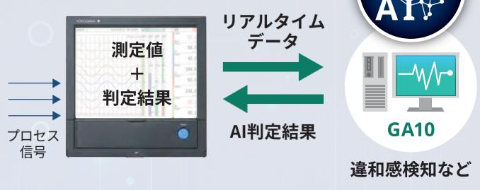
3 装置組込みで高精度AI解析、判定結果を表示
