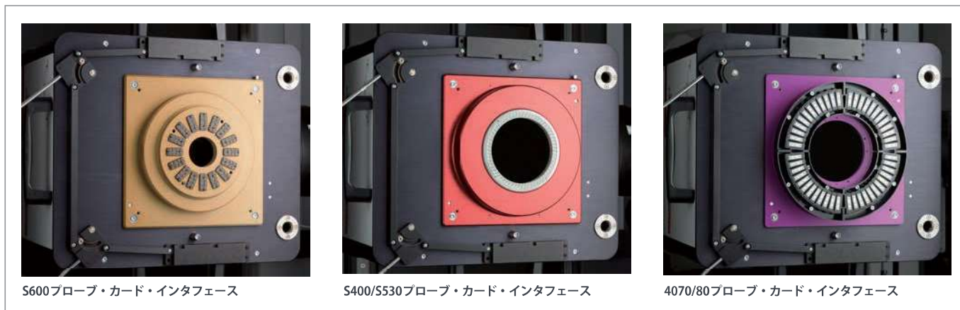
図4：テストヘッドの底部のプローブ・カード・インタフェース
