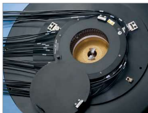
図5：プローバにインストールされた9139B-PCA型プローブ・カード・インタフェース・オプション
