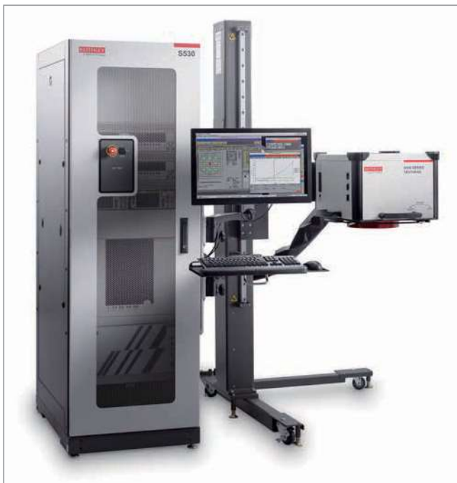
図2：S530型と、Reid-Ashmanのマニピュレータにドッキングされたオプションのテストヘッド
