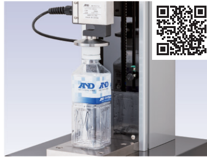
ペットボトルの圧縮強度試験
