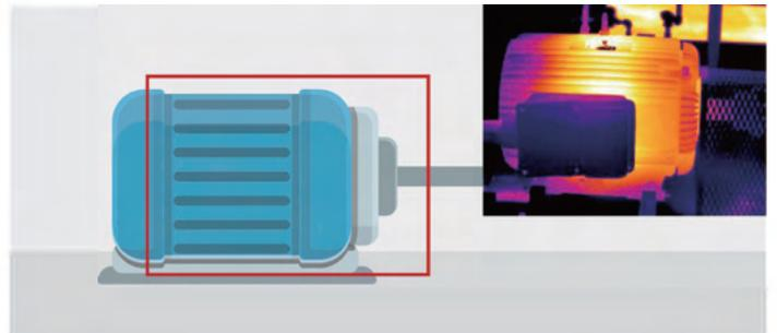
モーターとその潤滑剤が経年劣化すると、ベアリングが摩耗し、モーター・ベアリングに発熱を伴う摩擦が発生し、ベアリング・ハウジングの外側が熱くなります。
