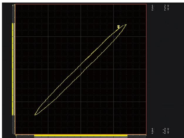
トルクと電流、圧力と流量など2変数の関係を確認するために、X-Y 表示画面では任意の2パラメータを可視化。
