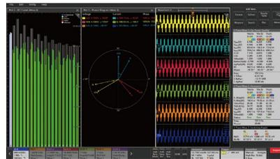
入力、出力、リップル、3つの主要な三相電気測定を自動化。画期的なオシロスコープベースの位相図に加え、同時にドライブの入力/出力電圧と電流信号を時間軸で観測可能。
