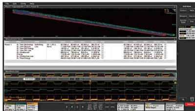
電力品質、入力容量、突入電流、高調波、スイッチング・ロス、安全動作領域、変調、リップルなどの電源自動測定に加え、磁気測定、制御ループ応答、電源電圧変動除去比の機能も提供。
