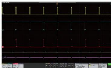
レコード長を62.5Mポイントに拡張することで、数千のシリアル・パケットでも1回で取込むことができ、高い分解能のままズーム表示して詳細に信号を観測可能。
