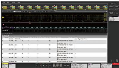
I<sup>2</sup>C、SPI、RS-232などのコンピュータ・バス、CAN、CAN FD、LIN、FlexRay、SENTなどの車載バス他、USBやEthernetなど、豊富なシリアル・バスに対応。
