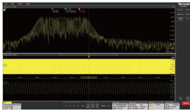
Spectrum Viewのオプション、RF対時間のハードウェアトリガ。RF信号の挙動を簡単に分離、捕捉、検査可能。RF振幅対時間やRF周波数対時間のエッジ、パルス幅、およびタイムアウトでもトリガ可能。
