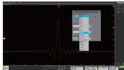
周波数50MHz(正弦波)、5Vpp出力の内蔵AFG機能の追加。正弦波、方形波、パルス波、ランブ波、三角波、DCレベル、ガウシアン、ローレンツなどのファンクション波形+任意波形。
