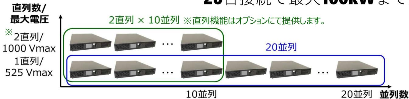
図 100 kWシステム構築例
