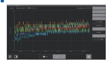
200 チャンネルの温度データから最大 10 チャンネルを任意選択、リアルタイムにトレンドデータを表示します。瞬時に比較したいデータの重ね描きを確認することができます。
