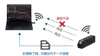
通信状況が不安定でデータが送信できなかった場合に複数回データを再送信し、リアルタイムデータの欠損を防止します。また、欠損データがあった場合でも計測モジュール側にすべてのデータを保存しており、計測終了時に欠損データを再送します。
