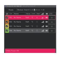
温度計測モジュールの電源ONでソフトウェア側のチャンネル部分が点灯し、設置した温度計測モジュールのチャンネルが識別でき設置間違いを防止できます。
