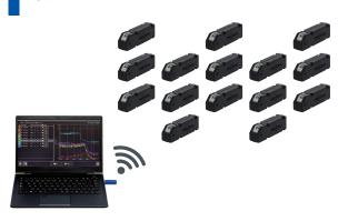
最大200チャンネルの同時温度計測により、分散した場所の温度を同時に把握することができ、広範囲で詳細な温度分布の計測が可能です。また最速100 msのサンプリング周期でリアルタイム計測が可能なため、急な温度変化も見逃しません。
