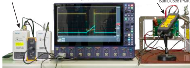
GaNデバイス評価基板のスイッチング電圧・電流 測定例
