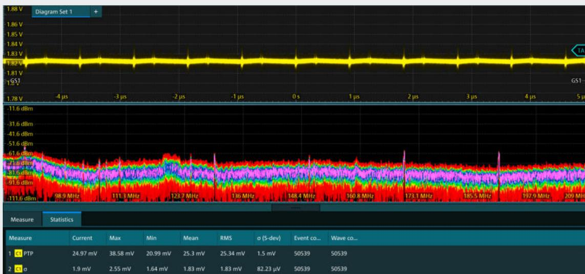
タイムゲーティングを用いたスペクトラム解析により、パワーレールのノイズに寄与する結合ソースを効果的に検出することができます。
