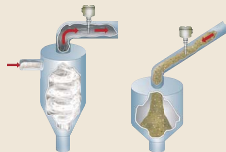
▲サイクロン詰まり検知 集塵機異常検知
