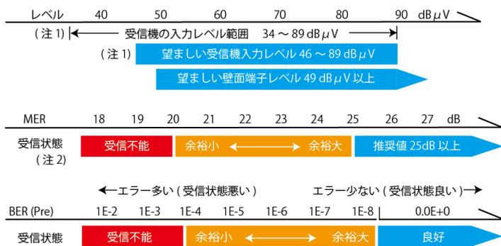
デジタル放送は、マルチパス (建物等による反射波) やフェージング (時間によるレベル変化) の影響があるため、安定した受信をするためには、映像が映る最低レベルに対して10~20dBの余裕を確保することが必要とされています。地上デジタル放送に対応したシグナルレベルメーターで、正確なレベルを測定してください。
