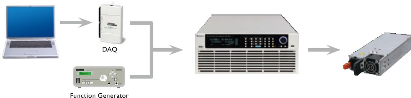
実際の電流プロフィールと波形をシミュレーションするため、ユーザー定義波形（UDW）に対応した拡張機能を有しています。実際の電流波形を再構築するために、ユーザーはソフトパネル（オプション）を介して、取得した波形データをアップロードすることが可能です。より厳しい試験要求に対応するため、最大150万のデータポイントからなる10セットまでの波形を保存することが可能です。
