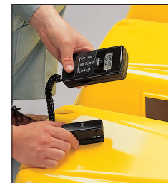
塗装後の外観検査
