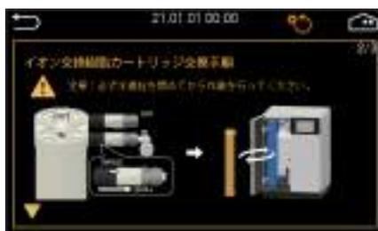
イオン交換樹脂や前処理フィルタの交換はお客様で行って頂きますが液晶画面で交換方法が表示されますので取扱説明書をいちいち取り出すことなく簡単に交換できます。
