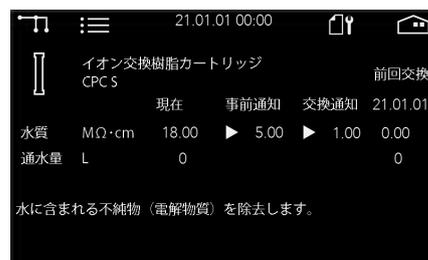
消耗品は交換履歴が記録されます。その他に交換通知、定期メンテナンス通知、異常の発生履歴も表示出来ます。また消耗品の購入計画など予算設定の参考にもお使い頂けます。
