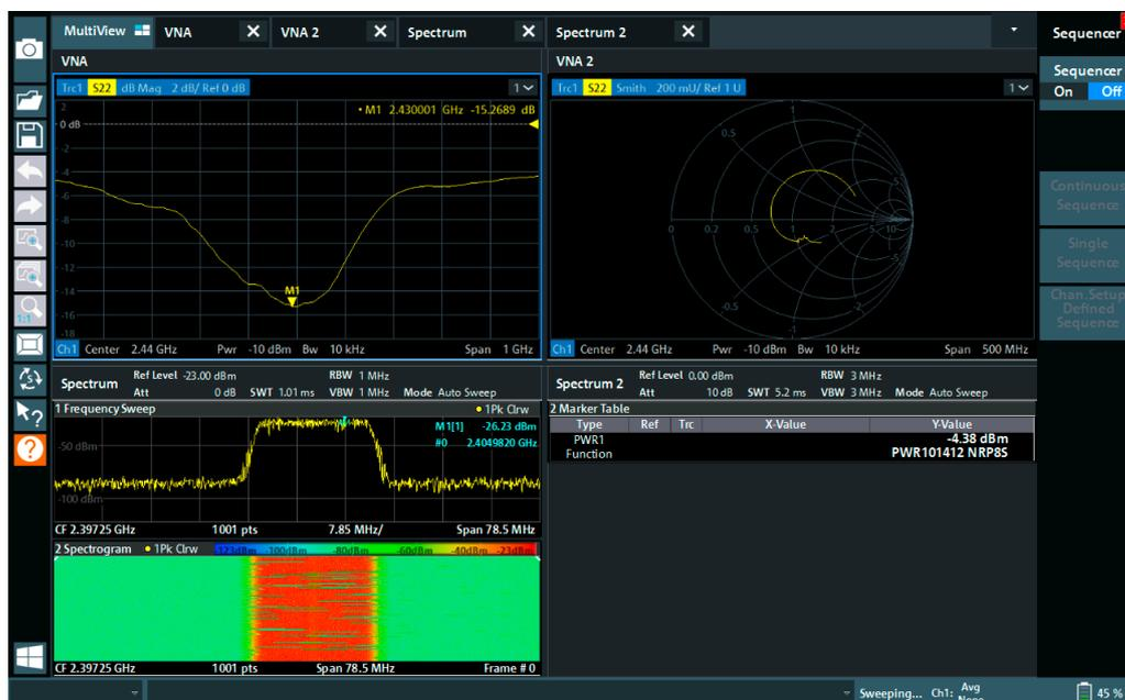
MultiViewモードでは、アクティブな測定がすべて同時に表示されます。ここでは、ベクトル・ネットワーク・アナライザ測定（2種類の異なる表現）がスペクトラム・アナライザ測定と一緒に表示されています。
