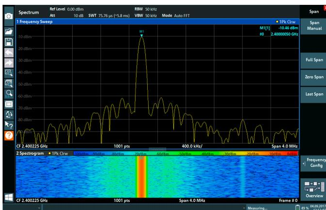
スペクトラム・アナライザ機能には、デジタル信号解析の標準機能であるI/Qアナライザが含まれます。このアプリケーションは、I/Qデータの測定／表示機能を備えています。捕捉したI/Qデータをサードパーティー製のソフトウェアツール(MATLAB®やPythonなど)に転送し、さらに解析を行うことができます。40 MHz解析帯域幅オプション(R&S®FPL1-B40)を使用することで、最大40 MHz帯域幅のシングルキャリア信号の解析と復調が可能です。
