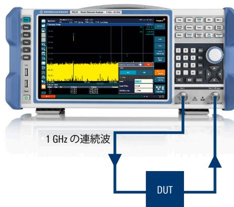
1 GHzで0 dBのCW入力信号を使用した、コモン・モード・トランス出力信号の周波数掃引。
