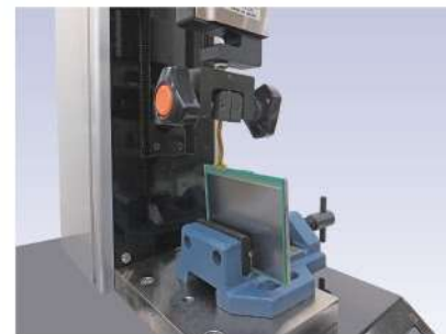
包装容器の突き刺し強度試験
