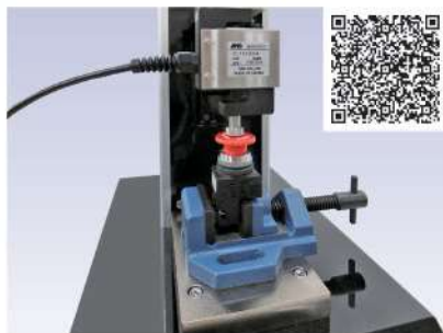
包装容器の圧縮強度試験
