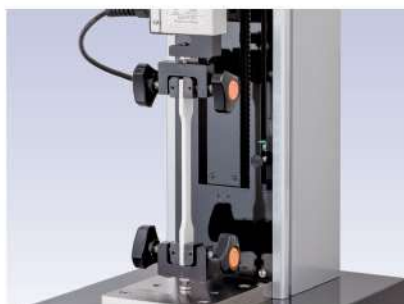
PTP包装の薬剤押し出し力試験
