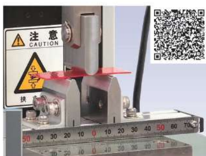
板材の曲げ強度試験
