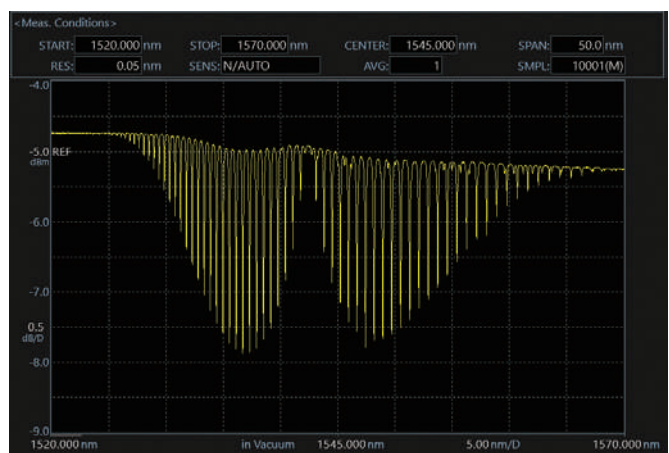
シアン化水素 H 13 C 14 N の光吸収スペクトル測定例 (AQ6375E)
