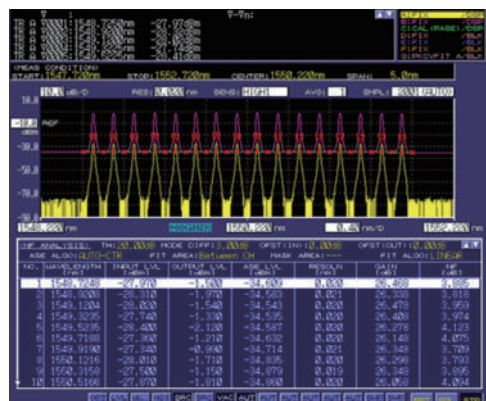
図3. EDFA-NFの解析結果例 (AQ6370D)
