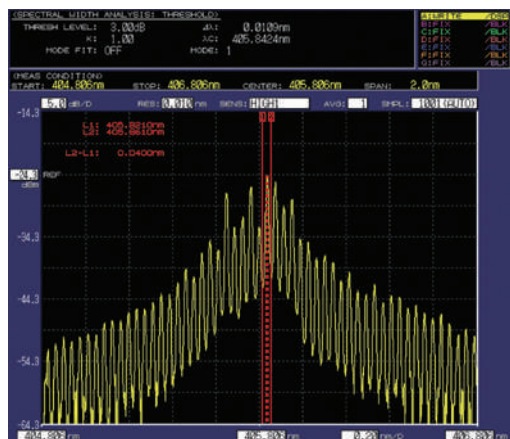
405nm FP-LD の測定例 (分解能設定 : 0.01nm)
