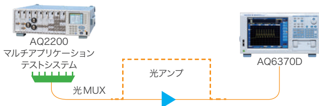
図1. 光ファイバーアンプ測定システムの例
