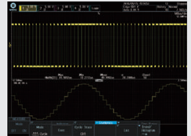
波形パラメータ(パルス幅)のトレンド表示例
