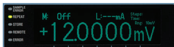
\pm 120,000 表示カウント、最小100nVステップの高分解能出力
