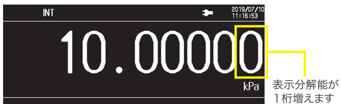
例：-G01 (10kPa ゲージ圧モデル)
