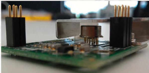
心臓部の基準電圧源は社内の特別な検査を通過した選別品を採用し、本体組み込み前にも長時間の評価を行っています。さらに、HIOKI 独自のフルオート校正「Self-calibration」との組合せにより 1 年保証 9 ppm(DM7276) という高確度を実現しました。
