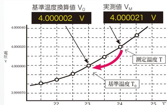
温度補正演算式  $V_0 = V_M / (1 + \alpha (T - T_0))$
