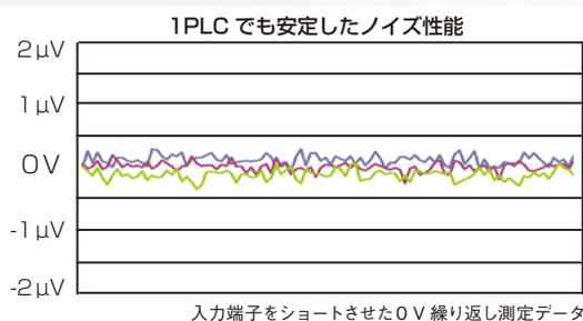
温度変化に敏感な受動部品の影響を最小にする回路設計と Self-Calibration が安定した測定を提供します。
