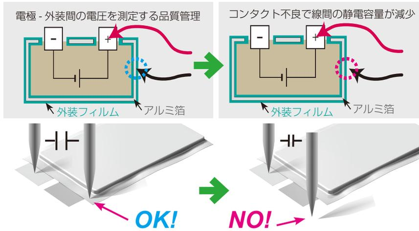
リチウムイオン電池の外装フィルムの絶縁不良検出に外装電位測定が有効です。外装をモールドされているリチウムイオン電池のような測定には精度だけでなくプローブ接触信頼性が重要になります。DMシリーズは測定対象にストレスを与えない10 mVrmsの微小信号で計測プローブ間の静電容量を測定しコンタクトを確認します。しきい値の設定用にキャパシタンスモニタを搭載しており、測定値を確認しながら設定ができます。
