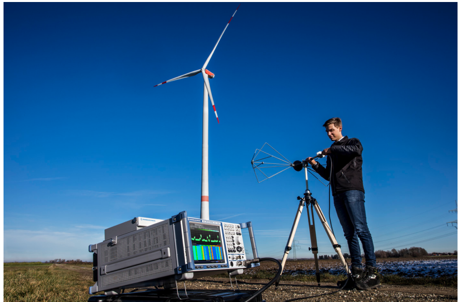
現場での測定のために、R&S®ESRにバッテリーを使用した例。
