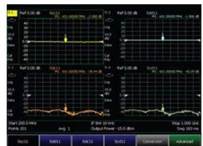
ミックスドモードSパラメータ測定によるCOMMONモード反射と差動モード反射の特性評価
