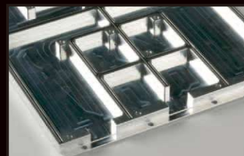
ソリッドシールド内部
