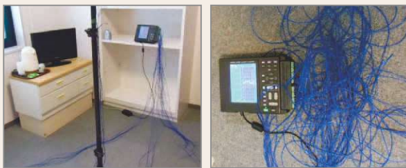
測定箇所から長い配線を引き直し
