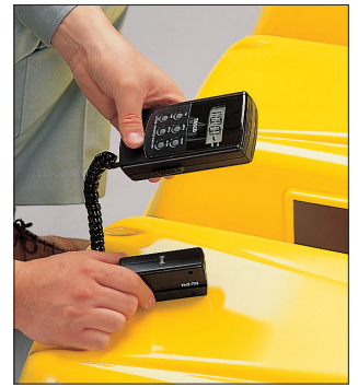
塗装後の外観検査
