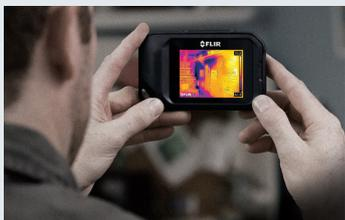
明るい3インチスクリーンはタッチパネルで直感的な操作が可能。本体の向きによって横・縦表示が切り替わる自動回転機能も搭載。
