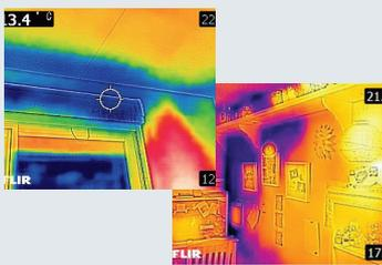
可視カメラで撮影した画像の輪郭だけを熱画像に合成する画像補正機能MSX(スーパーファインコントラスト)を搭載。これにより、視認性が飛躍的に向上します。
