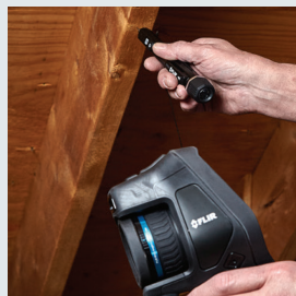
サーマルイメージのクールドスポットが水分かどうかを確認可能
