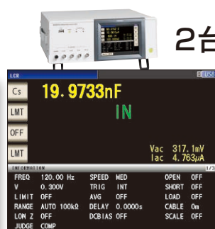
LCR モード Cs 表示画面(1 kHz 測定)
