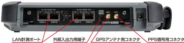
LE-8500X/LE-8500XRは1 GbE計測が可能な4つの計測用LANポートを装備し、ポートA-B間およびポートC-D間に分岐接続されたLANケーブル上を流れるイーサネットパケットを2チャンネル同時測定可能。ポートA-B間は、イーサネットパケットとPoE電力の同時計測にも対応しているの、最大で1 GbE 2chのパケットとPoE 1chを同時に計測、記録できます。
