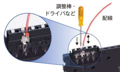
調整棒やマイナスドライバなどで白い電線挿抜用ノブを押し下げて電線を挿抜します。フェールルなど先端が硬い場合はそのまま挿入できます。
