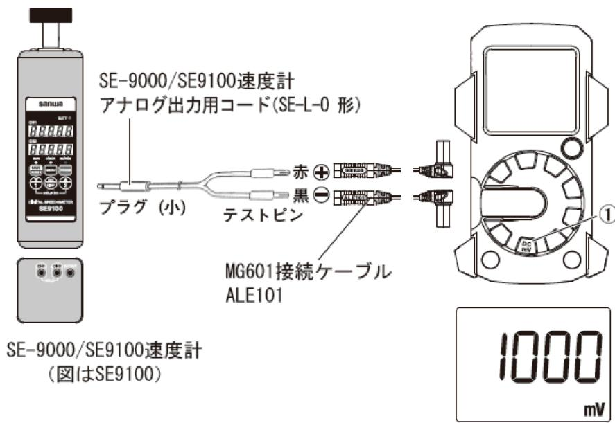
※読み取り例: 測定値 1000[mV] の時、速度 1000[m/min] となります。
