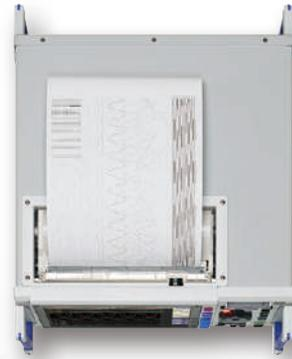
紙送り速度従来比2倍で、且つ高精細な印字を実現。A4サイズで大きく波形を描き出し、現場での確認を容易にします。
