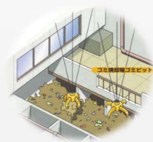
ごみピット・バイオマス
