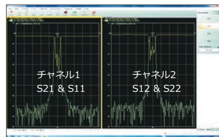
フィルタの応答およびリターンロス測定例
