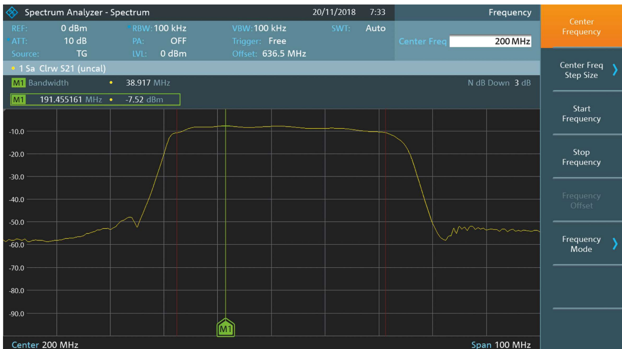
R&S®FPC1500: ミキサー、フィルター、増幅器を含む信号チェーンをトラッキングジェネレーターで測定
