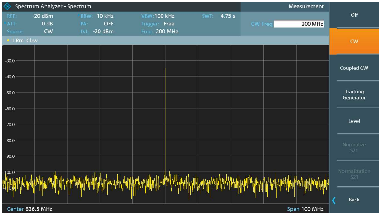
R&S®FPC1500: 信号発生器の信号をスペクトラム・アナライザ・モードで測定
