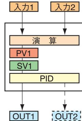
※二出力(加熱冷却制御)も行えます
