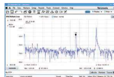
DTF機能を使用したケーブルの障害位置検出
