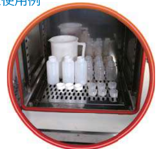
最下段棚板を外し 底板上に直接試料を置く
