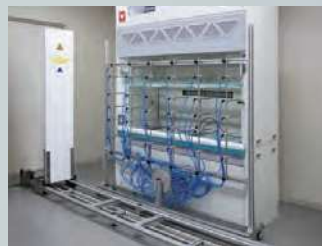
多点風速計による風速測定
