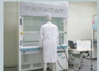
ASHRAE 試験 positioning 試験
