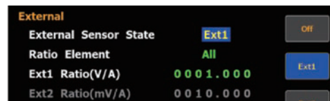
2系統の外部電流センサー入力
