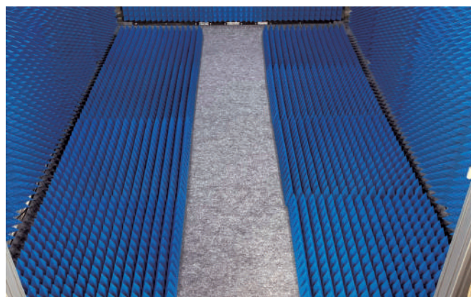
床面電波吸収体を部分的に取り外した状態
