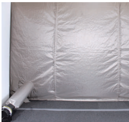
正面扉 シールドテント 閉口時
