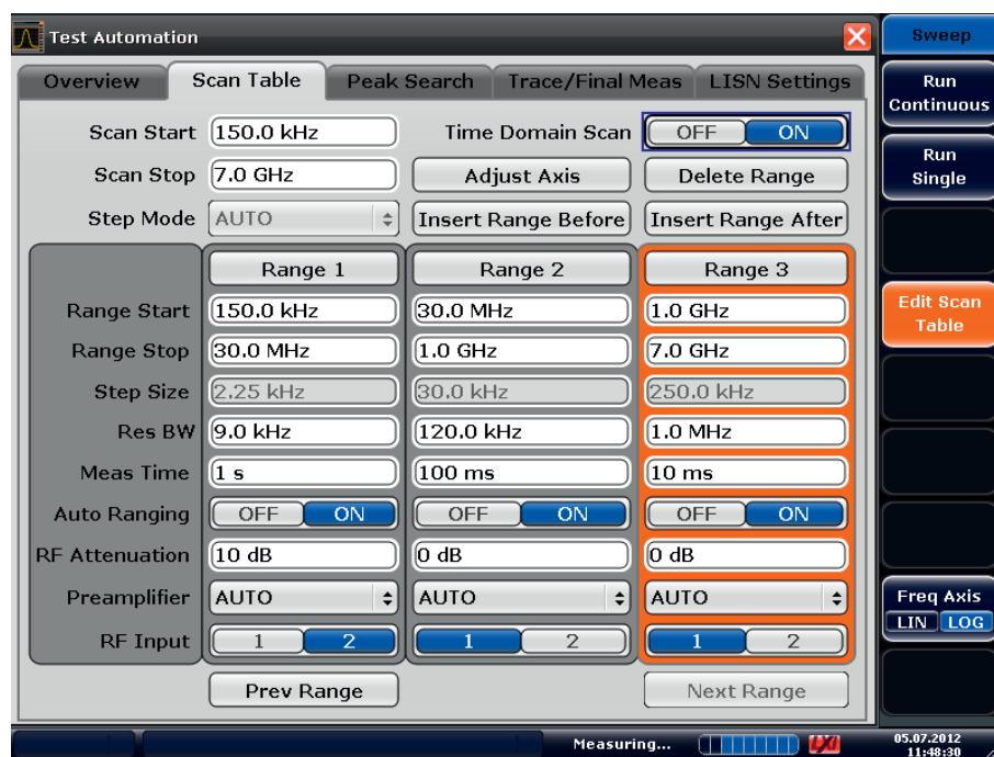
R&S<sup>®</sup>ESR のレシーバ・モードでは、スキャン・テーブルで定義した内容に従って周波数範囲が設定されます。スキャン・テーブルは、10 の周波数サブレンジ（スタート/トップ周波数、ステップ幅、測定時間、分解能帯域幅、入力減衰量）を設定することができます。
