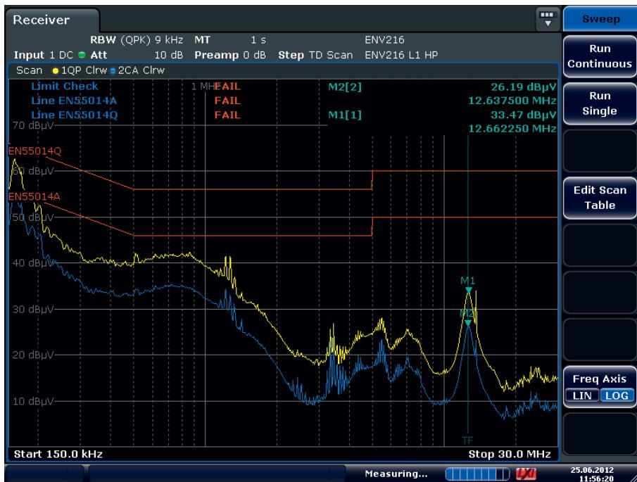
R&S<sup>®</sup>ESR は、QP検波器と平均検波器を併用した妨害波電圧測定を、わずか数秒で実施することができます。
